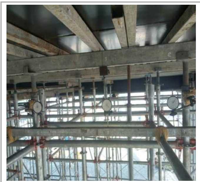
Thí nghiệm kiểm tra chất lượng an toàn chịu tải của giàn giáo tại công trường
