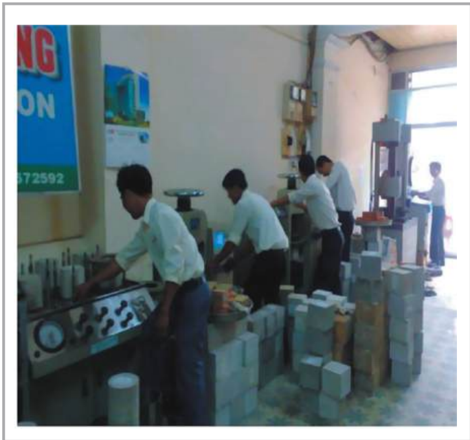
Thí nghiệm chống thấm BT, TN nén uốn bê tông
