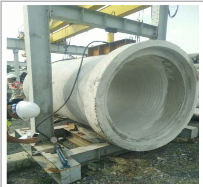
Thí nghiệm kiểm tra chất lượng thử nén cống
