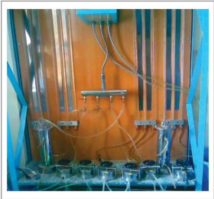
Thí nghiệm hệ số thấm K của đất
