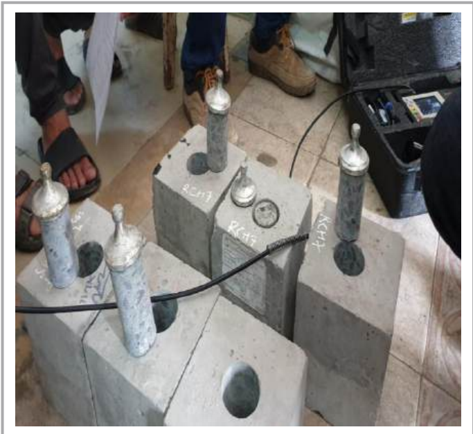
Thí nghiệm cường độ bám dính bê tông
