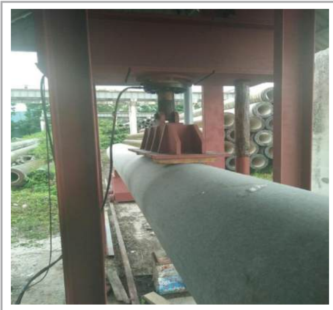
Thí nghiệm kiểm tra chất lượng thử uốn cọc ly tâm
