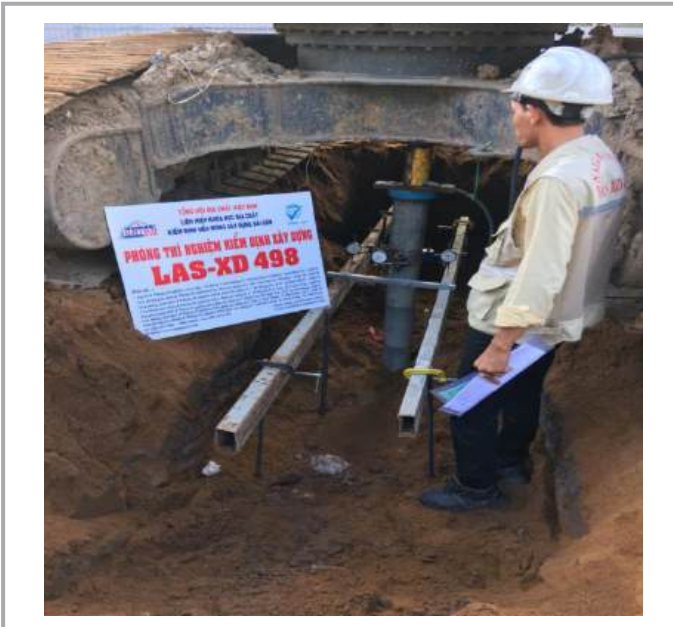
Thí nghiệm kiểm tra sức chịu tải đất nền tại công trường
