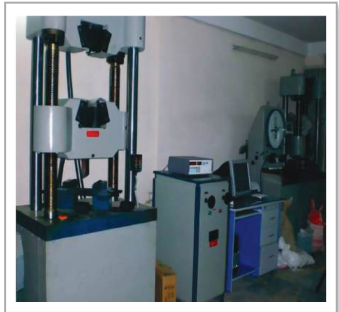
Máy kéo thép, cáp điện tử, các thông số kỹ thuật hiển thị trên màn hình máy vi tính
