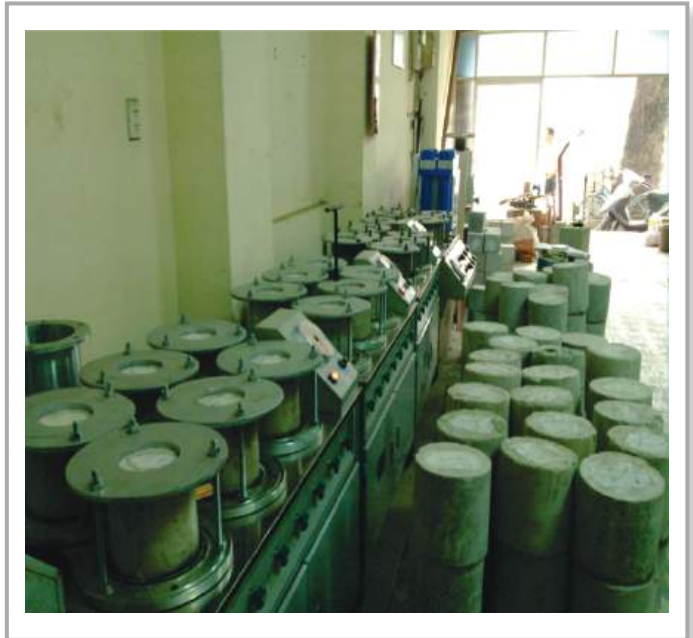
Thí nghiệm xác định độ thấm nước của bê tông
